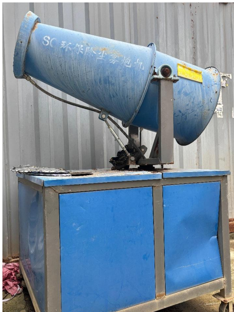
施工期雾炮机（大气污染防治）
